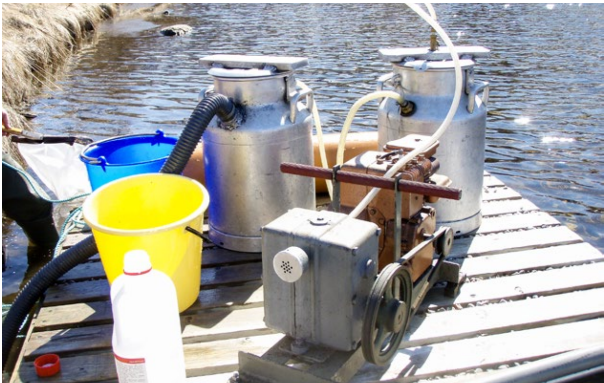
Figur 3. Sugeapparat for kvantitative bunnprøvetaking i stilleflytende vann. For virkemåte henvises til tekst (fra Ekse i 2010). Foto: A. Fjellheim
