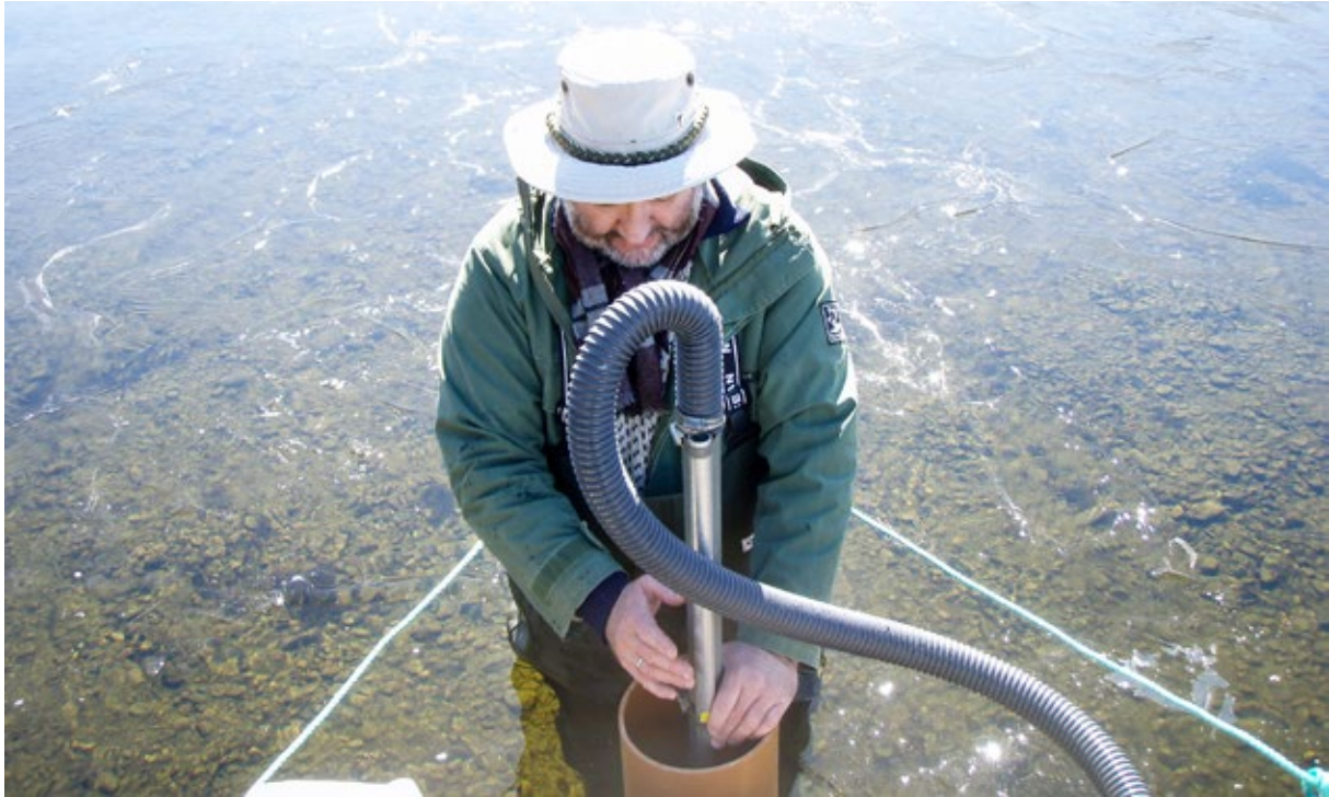
Figur 4. Prøvetaking terskelbassenget på Ekse. En person tar prøvene mens en person betjener pumpeutstyret fra en flåte (fra Ekse i 2010). Foto: A. Fjellheim
